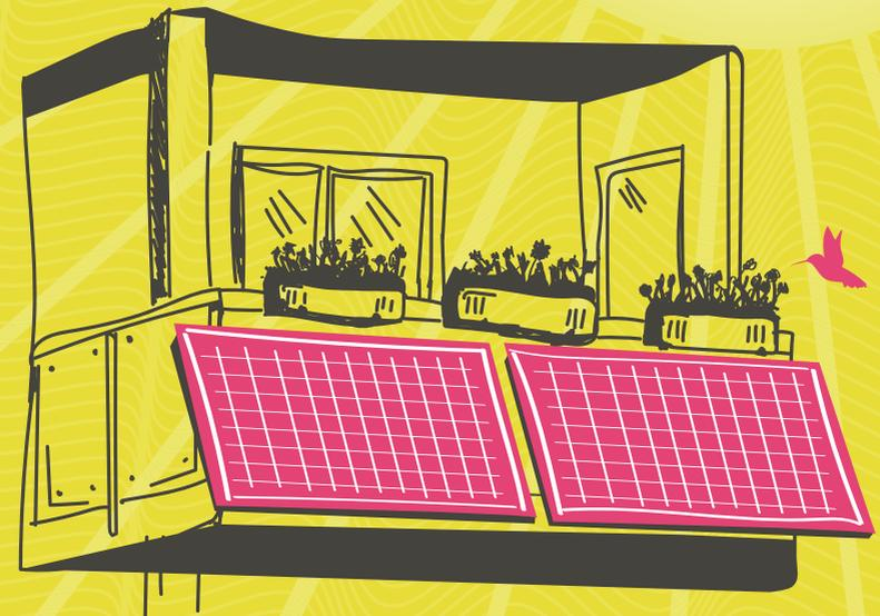
Balkonkraftwerke sind kleine und günstige Solaranlagen, die einfach in die Steckdose gesteckt werden und dann den selbstproduzierten Strom in dein Hausnetz einspeisen.
